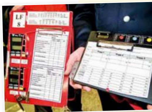
Mit einer wesentlich handlicheren und weiter entwickelten Ausführung wurde das Atemschutzüberwachungsbrett der Feuerwehr Calw optimiert
